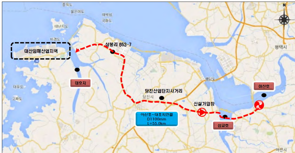
[그림 IV-6] 아산호~삼교호~대호지 도수관로 연결 계획평면도
